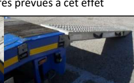
Positionner les rampes dans les rainures prévues à cet effet
