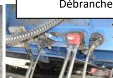
Débrancher les flexibles hydrauliques
