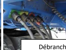
Débrancher les flexibles hydrauliques
