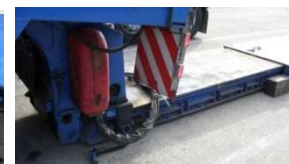
→ Enlever les cales de soutien → baisser le col de cygne → contrôler le positionnement de la poutre
