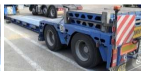
Serrer le frein de parc de la remorque → Mettre la suspension en position basse
