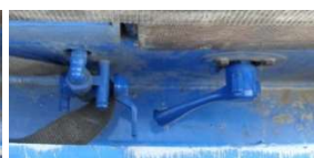
Serrer le frein de parc de la remorque → Mettre la suspension en position basse
