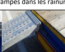
Positionner les rampes dans les rainures prévues à cet effet
