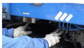
→ Enlever les cales de soutien → baisser le col de cygne → contrôler le positionnement de la poutre
