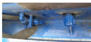
Serrer le frein de parc de la remorque → Mettre la suspension en position basse
